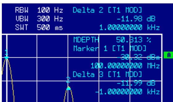
Fig. 5-7 Mesure du taux de modulation AM. Le taux de modulation affiché est MDEPTH. La fréquence du signal AF est indiquée dans la zone d'affichage de la fréquence des marqueurs delta.
